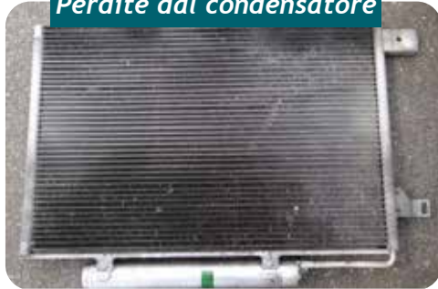
Perdite dal condensatore
